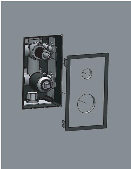
Posizionare il telaio UniFrame con la piastrella all'interno della UniBox.
